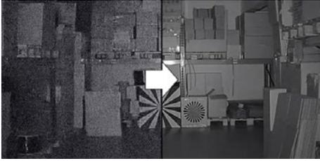
Bildrauschen tritt bei vielen Kameras besonders häufig in lichtschwachen Situationen auf. Der Effekt wird durch eine hohe Verstärkung verursacht. Die digitale Rauschunterdrückung reduziert das Rauschen und kann so den Speicherplatzbedarf der Aufnahmen am Recorder verringern.
