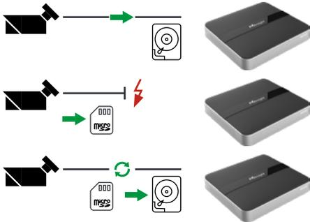
Die Funktion ANR dient zur unterbrechungsfreien Aufzeichnung, wenn die Verbindung zur Kamera unterbrochen wird.
